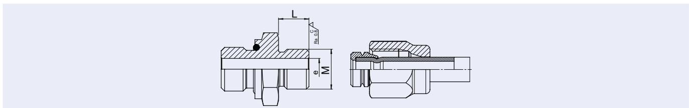
Die Stirnseite des Gewindezapfens muss wegen der metallischen Abdichtung des SERTO Anschlusses feingeschliffen, plan, frei von Rattermarken und rechtwinklig zum Gewinde sein.
